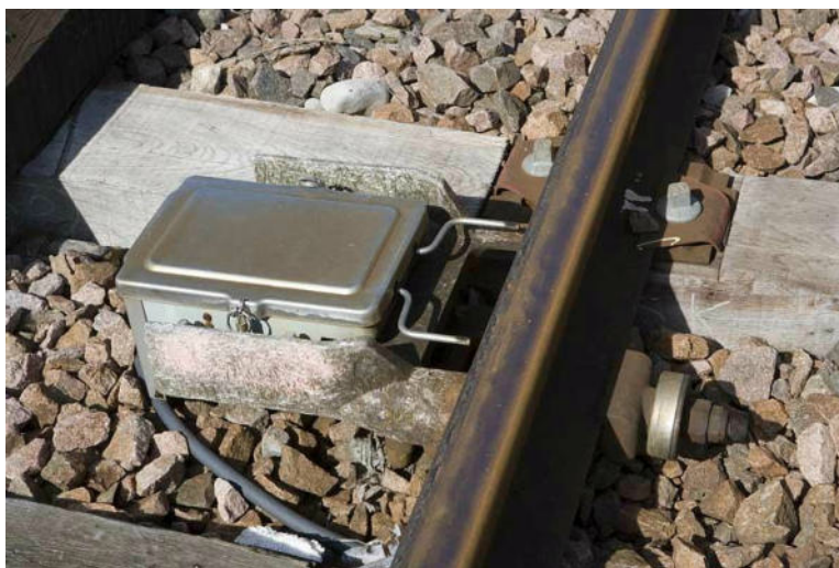
Pedale di comando SILEC tipo Forfex direzionale
